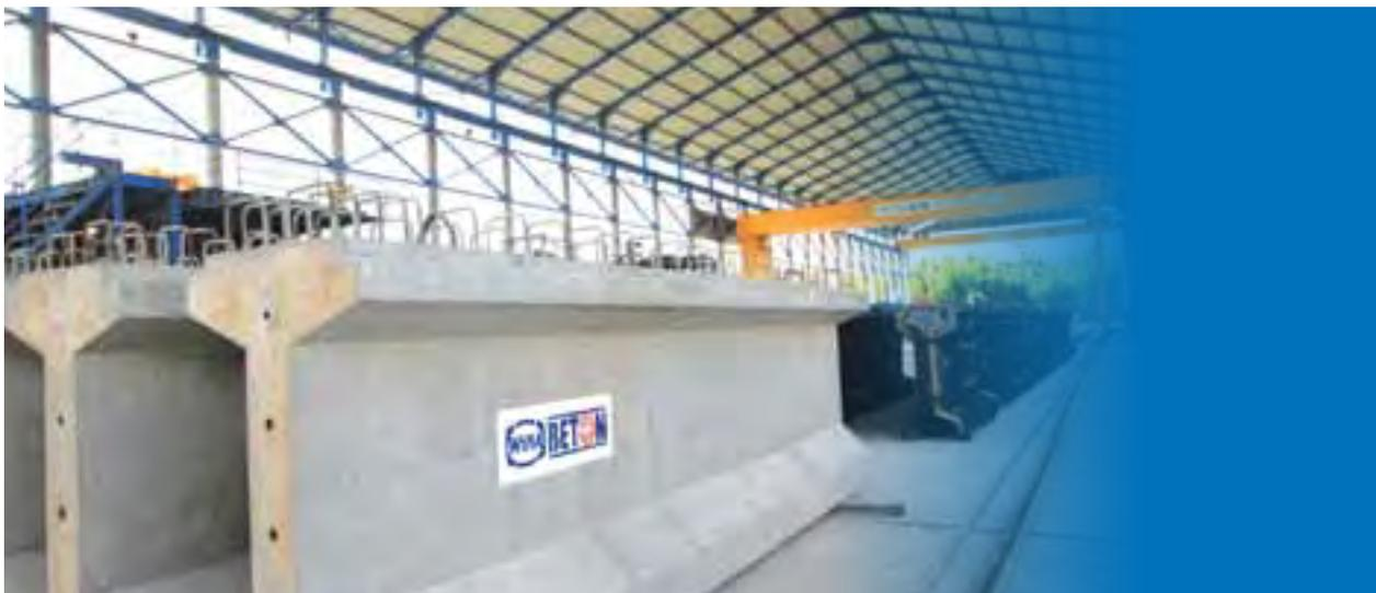
Berdasarkan proses *stressing*, produksi balok jembatan dapat dibagi menjadi dua cara, yaitu *pre-tension* dan *post-tension*. Proses *stressing* tersebut tergantung dari kondisi dan permintaan pelanggan.
